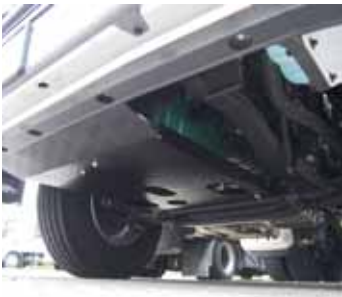
Ein stabiles Blech schützt Kühler und Ölwanne.
