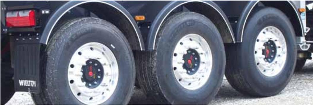
**Offroadtauglich: Die Bremszylinder der SAF-Achsen werden im Achslenker sicher verwahrt.**
