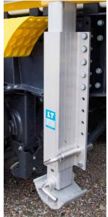
**Optional mit Fallstützen: Leicht zu handhaben, beide Stützen wiegen nur 40 kg.**
