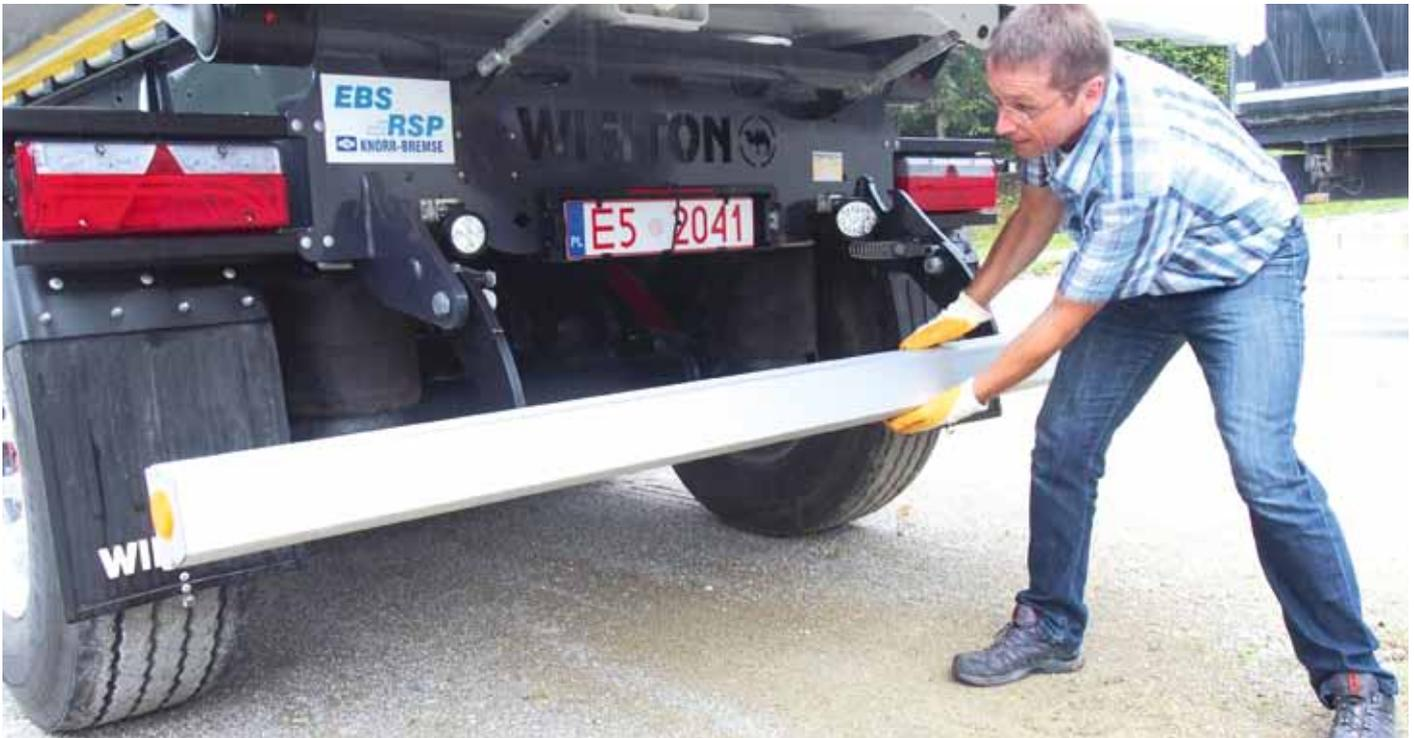
**Klappbar mit Federkraftunterstützung: Der Heckunterfahrerschutz lässt sich mit geringem Körpereinsatz anheben.**
