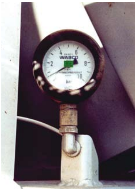
Optional: Ladekontrollmanometer. Bild rechts: Der Unterfahrerschutz lässt sich dank Federunterstützung leicht hochklappen.
