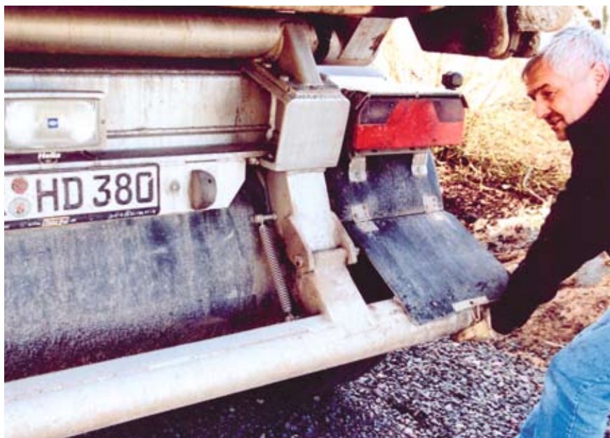
Optional: Ladekontrollmanometer. Bild rechts: Der Unterfahrerschutz lässt sich dank Federunterstützung leicht hochklappen.
