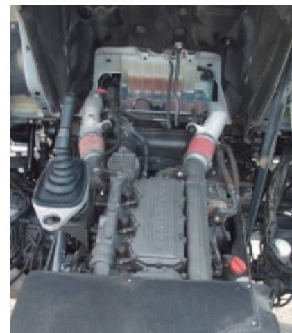
Der 9,2-l-Hightech-Diesel von DAF Trucks mit UPEC-Direkteinspritzung.
