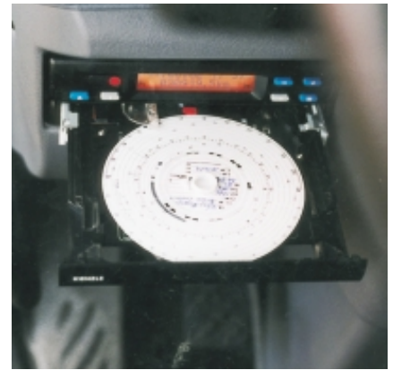
In Kniehöhe: separater Tachoschacht
