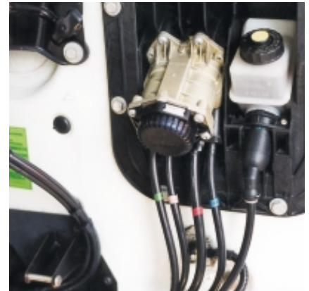
verlangt Kraft: das Betriebsbremsventil
