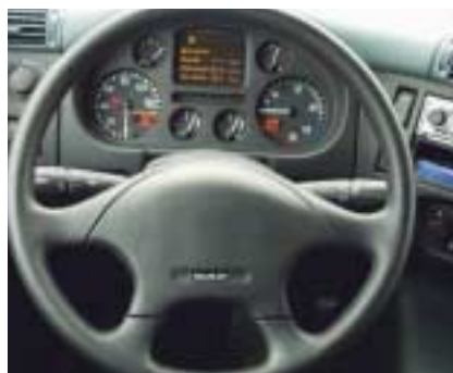
Übersichtlich: Gut ablesbare Rundinstrumente und ein zentrales Informationsdisplay prägen das Instrumentenbrett.
