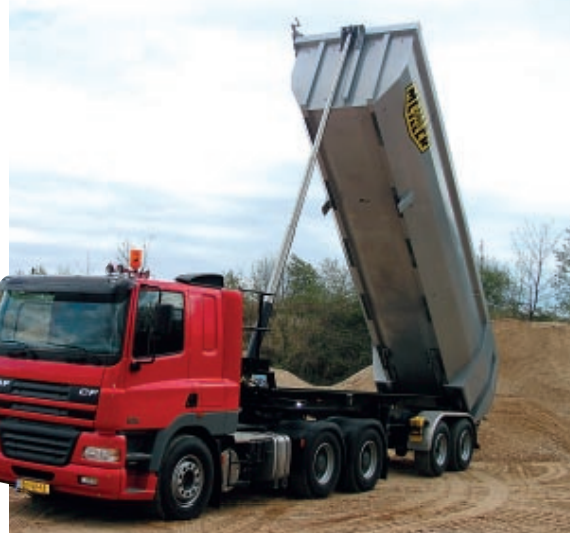
Die Ecas- und die absenkbare Luftfederung im Meiller-Muldenkipper erhöhen die Kippsicherheit.
