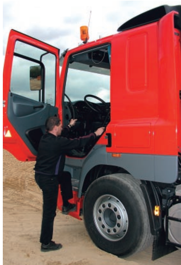
Die tief gesetzte Trittstufe aus nachgiebigem Kunststoff ermöglicht einen bequemen Einstieg.
