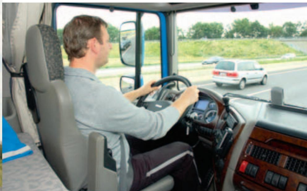
**Der Fahrer-Arbeitsplatz ist in allen Punkten vorbildlich gelungen. Ein praktischer Ausziehtisch in der Mittelkonsole, Kühlschrank für frischen Proviant und Kaltgetränke sowie Sitzschnellabsenkung und hochklappbares Lenkrad fürs bequeme Aussteigen sorgen für überdurchschnittlichen Komfort an Bord.**
