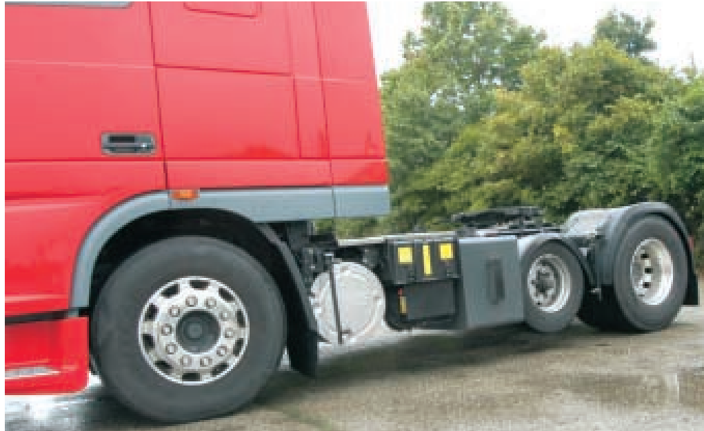
Das Bein gehoben – jetzt hat der 23,4-Tonner ein zulässiges Gesamtgewicht von 18 Tonnen
