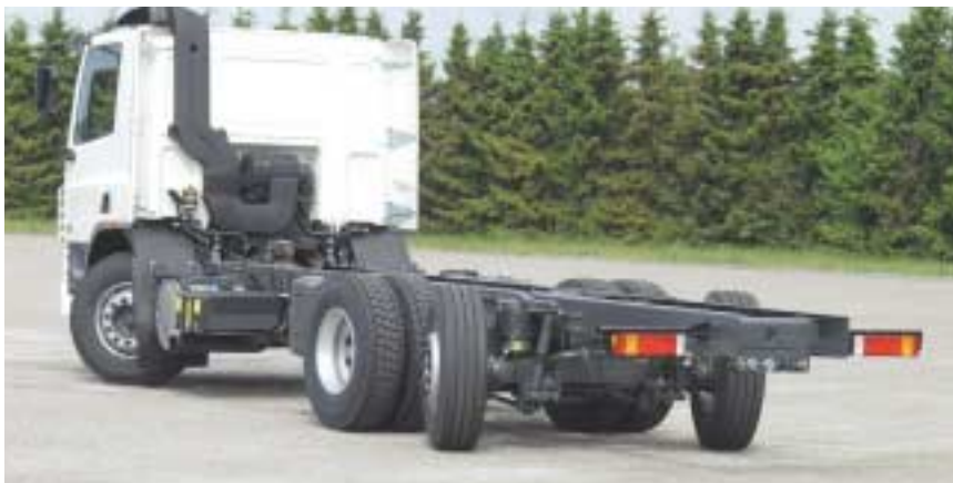
Wendig: Der CF-FAN 75.310 ist mit gelenkter Nachlaufachse vor allem bei engen Einsatzverhältnissen im Vorteil.
