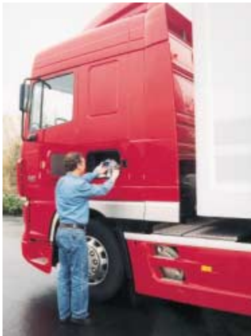
Praktisch: Für Reinigungsutensilien und Werkzeug gibt es auf der Fahrerseite ein nach innen geruchsdicht abgeschlossenes Staufach.
