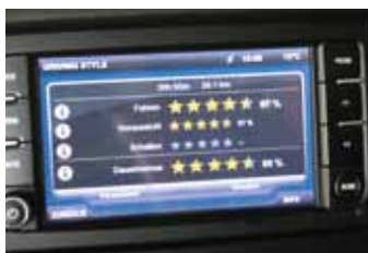
Sternenlob: Bewertung durch die Aktiv-Fahrstilanalyse des Stralis-Bordrechners.
