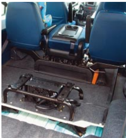
Nicht optimal: Eine Sitzreihe auszubauen gelingt nur mit Mechaniker-Qualitäten. Um den Sitzbock auszubauen, müsste man den Sperrholzboden herausreißen.
