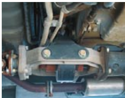
(links) Diese Viskokupplung aktiviert die Hinterachse bei Drehzahlunterschieden zwischen den vorderen und hinteren Rädern. (rechts) De-Dion-Hinterachse: Das Achsdifferenzial ist an der Karosserie befestigt, die Räder treiben homokinetische Wellen.
