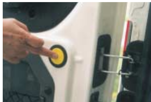
Optimal: Der gelbe Plastikknopf an der Hecktür entriegelt die Einraststellung völlig gefahrlos.
