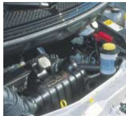
Der Transit mit Frontantrieb verfügt über einen quer eingebauten Motor mit 2 l Hubraum, ein sanfter und sparsamer Geselle.
