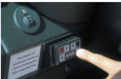
Per Fingertipp setzt der Fahrer erst den Nebenantrieb und danach links auf dem Bedienfeld die Kippbrücke in Bewegung.
