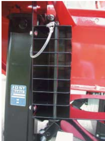
Dem Rost keine Chance: Oberflächenbehandlung mit KTL
