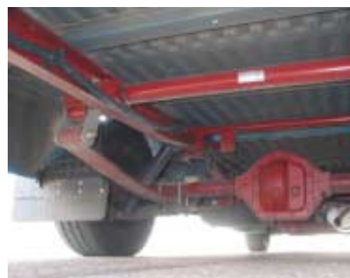
Die Hinterachse: Einfach blattgefedert. Auch ohne Stabgute Wankstabilität.
