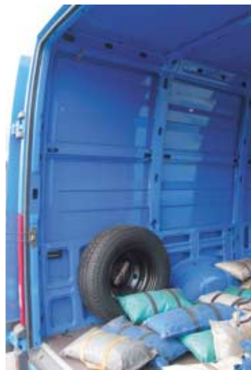
Das Reserverad kann auch unterm Boden Platz finden. Gut: die bis zur Gürtellinie kräftig ausgesteiften Seitenwände.
