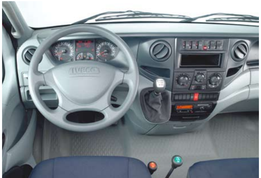
Ergonomisches Cockpit mit drei Schalthebeln; Nebenantrieb (PTO) und Kipphydraulik. Nomenklatur bei Iveco: Offroad-Spezialfahrzeug mit 5,5 t zGG und 176 PS
