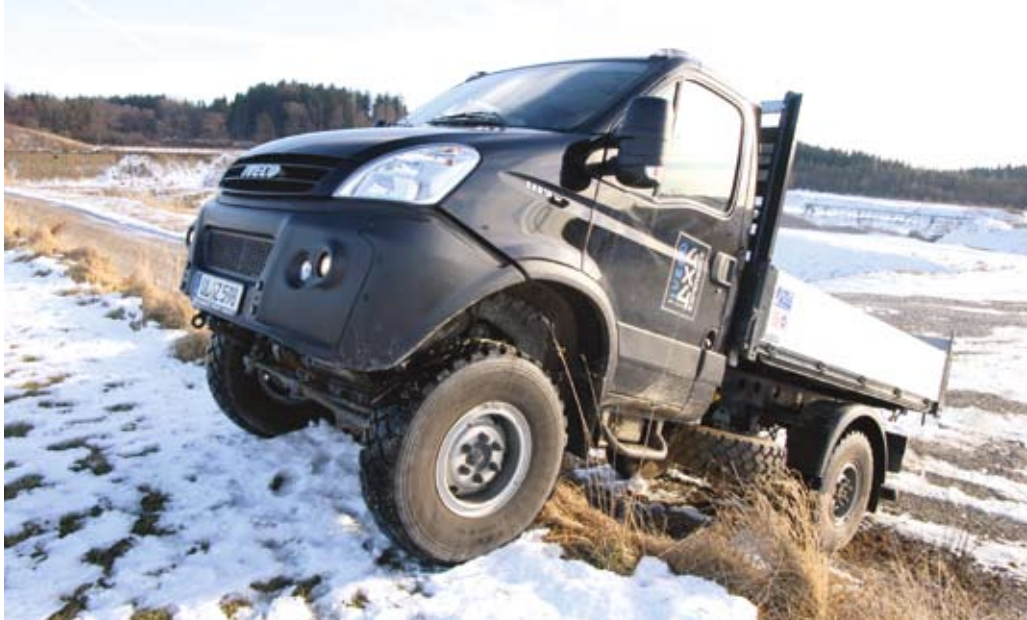
Klettert wie eine Bergziege – Differenzialsperren fürs Verteilergetriebe und an beiden Achsen
