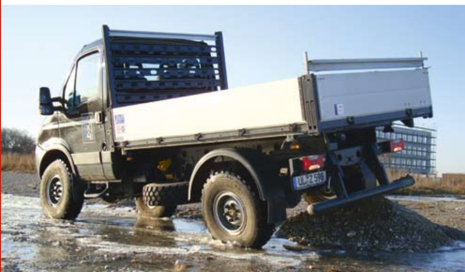
Bodenkontakt unter allen Bedingungen – dank weit verschränkbarer Achsen und verwindungsfreudigem Rahmen
