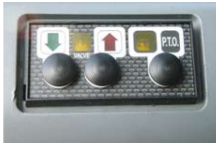
Ergonomisches Cockpit mit drei Schalthebeln; Nebenantrieb (PTO) und Kipphydraulik. Nomenklatur bei Iveco: Offroad-Spezialfahrzeug mit 5,5 t zGG und 176 PS
