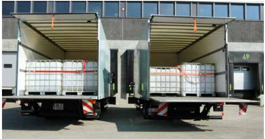
Gleiche Aufbau- maße, aber die Ladekante des Daily liegt niedriger.
