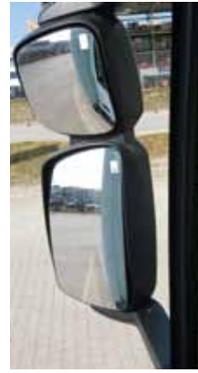
Angemessen groß und mit stabilen Bügeln: Die Außenspiegel des Eurocargo stammen aus den schweren Iveco-Trucks.
