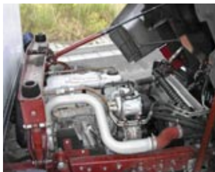
Unter der Kabine arbeitet ein erstaunlich kompaktes Kraftpaket, das aus 3,9 l Hubraum 170 PS abgibt.
