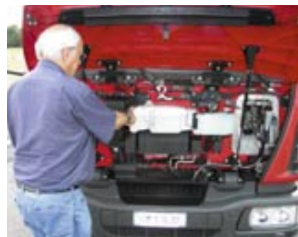
Beim Eurocargo besorgt die Elektronik den täglichen Routinecheck. Nachfüllstutzen wie fürs Scheibenwischwasser sind gut zugänglich.
