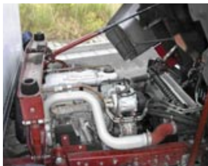
Unter der Kabine arbeitet ein erstaunlich kompaktes Kraftpaket, das aus 3,9 l Hubraum 170 PS abgibt.
