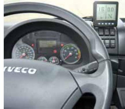
Das Zusatzinstrument informiert jederzeit über den Ladezustand der Batterie und den Leistungseinsatz der E-Maschine.
