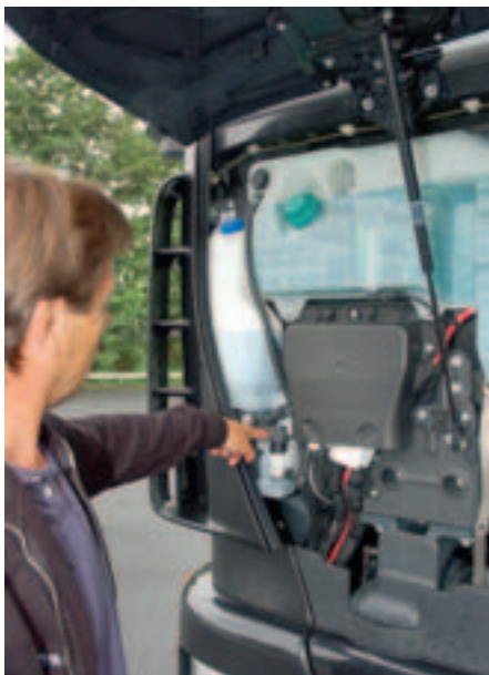
Den Routinecheck erledigt die Bordelektronik, alle Nachfüllpunkte sind einfach zu erreichen. In die Bugschürze integrierte Haltegriffe und rutschhemmende Tritte sorgen für einen sicheren Stand. Der klappbare Spoiler links vereinfacht den Aufliegerwechsel und den Zugang zum Kühlaggregat bei Kühlzügen.
