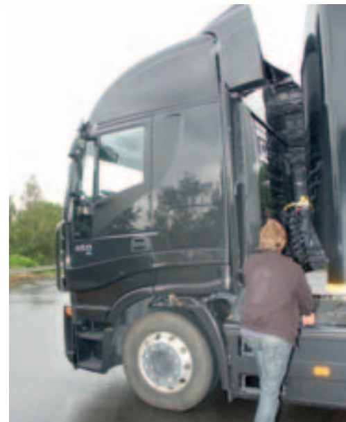
Den Routinecheck erledigt die Bordelektronik, alle Nachfüllpunkte sind einfach zu erreichen. In die Bugschürze integrierte Haltegriffe und rutschhemmende Tritte sorgen für einen sicheren Stand. Der klappbare Spoiler links vereinfacht den Aufliegerwechsel und den Zugang zum Kühlaggregat bei Kühlzügen.
