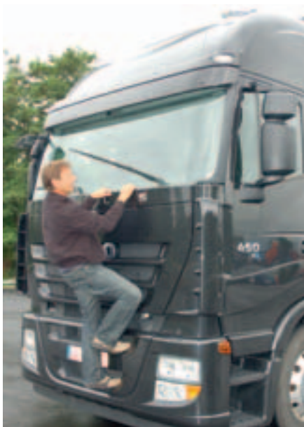
Den Routinecheck erledigt die Bordelektronik, alle Nachfüllpunkte sind einfach zu erreichen. In die Bugschürze integrierte Haltegriffe und rutschhemmende Tritte sorgen für einen sicheren Stand. Der klappbare Spoiler links vereinfacht den Aufliegerwechsel und den Zugang zum Kühlaggregat bei Kühlzügen.
