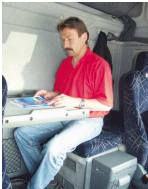
Die untere Liege lässt sich mit wenigen Handgriffen in eine gemütliche Sitzgruppe mit Tisch umbauen.
