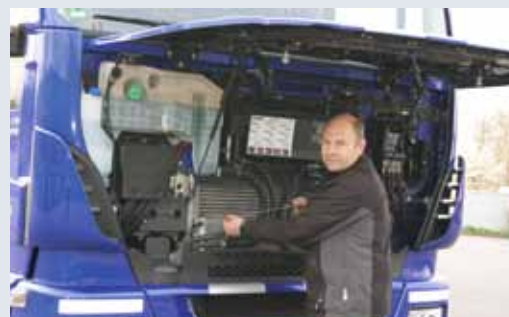
Zugänglich: Kontroll- und Nachfüllpunkte
