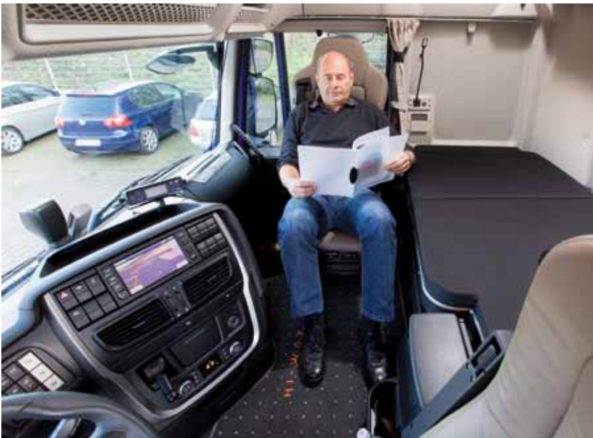
Entspannend: drehbarer Beifahrersitz
