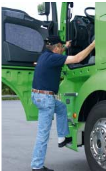
Der sichere Aufstieg zum praktisch ebenen Kabinenboden erfolgt über günstig aufgeteilte Trittstufen.
