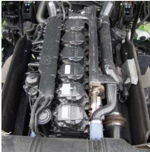
Der 6-Zylinder-Reihendiesel im MAN TG 510 A leistet satte 510 PS und besitzt ein maximales Drehmoment von 2.300 Nm.
