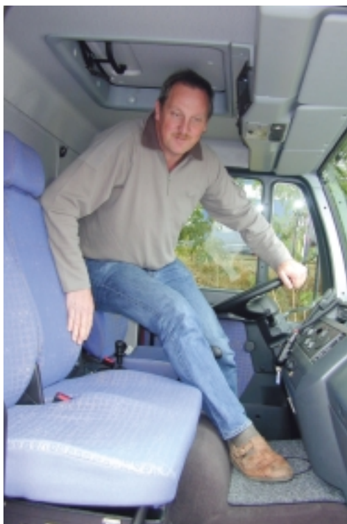
Gerade im Verteilereinsatz ist eine relativ einfache Durchstiegsmöglichkeit zur Beifahrertür wie beim LE2000 gefragt.
