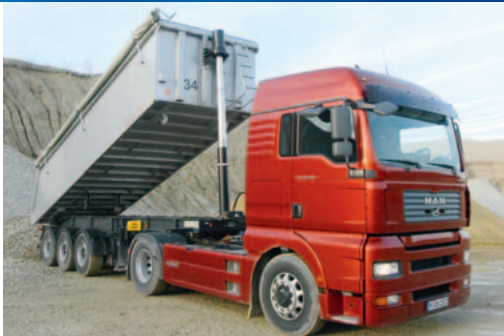
Kompaktdiesel D20 Common Rail, 400 PS bei 1.900/min, 1.900 Nm bei 1.000 bis 1.400/min. Leer aus der Grube – wenn die Achslast fehlt, hilft der Hydrodrive.
