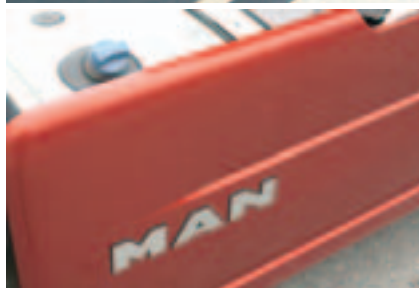
MAN hat drei Funktionen (Auftritt hinterm Fahrerhaus, Diesel- und Ad-Blue-Behälter) in den Tankkörper integriert.
