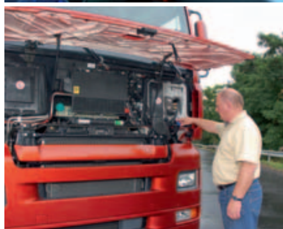
Die wichtigsten Betriebsflüssigkeiten werden elektronisch überwacht, die Einfüllstutzen sind einfach erreichbar (unten).
