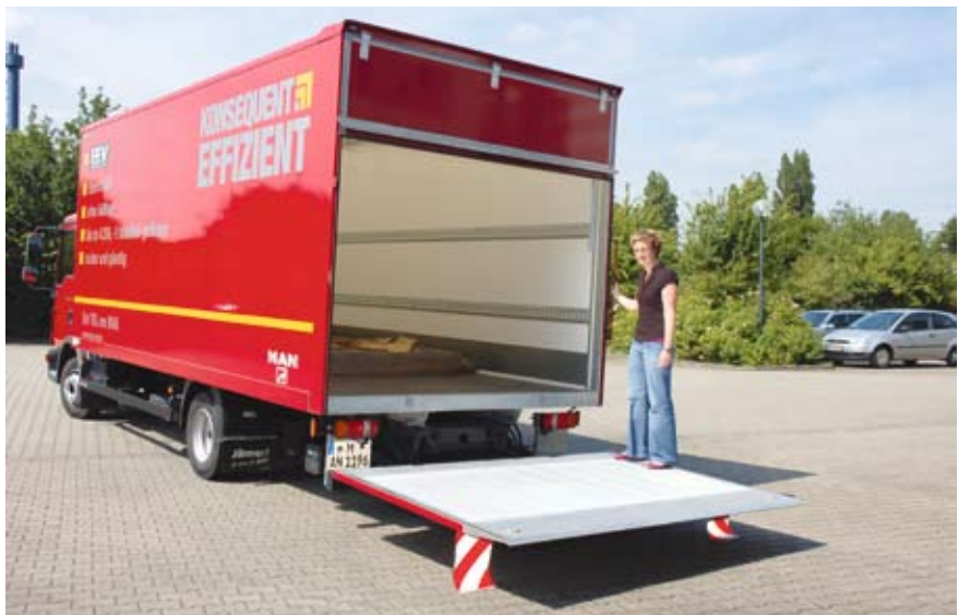
Wirtschaftlich: Mit Kofferaufbau und Ladebordwand sind etwa 2,2 t Nutzlast möglich.
