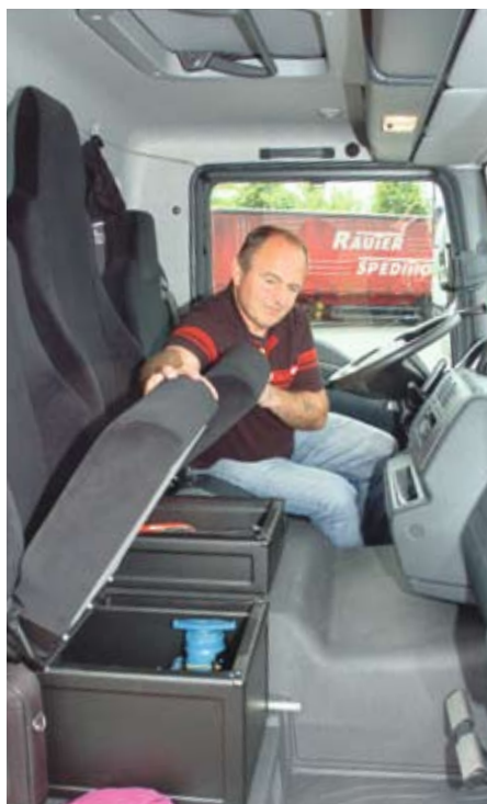
Praktisch: die Staukästen unter der Beifahrer-Doppelsitzbank (oben). Bequem: einfacher Scheinwerferbirnenwechsel bei gekipptem Fahrerhaus (unten links).
