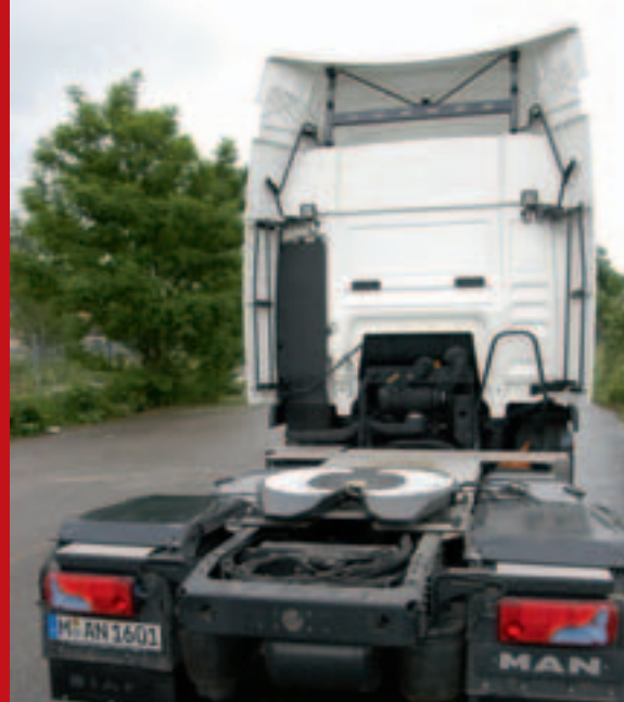
Maximalist mit 3,11 m Ladehöhe und 105 m 3 Volumen (oben links). Unerreichbar für schwere Zugmaschinen: Aufsattelhöhe 883 mm (oben rechts). Vorne und hinten kleine Räder im 17,5-Zoll-Format (unten).
