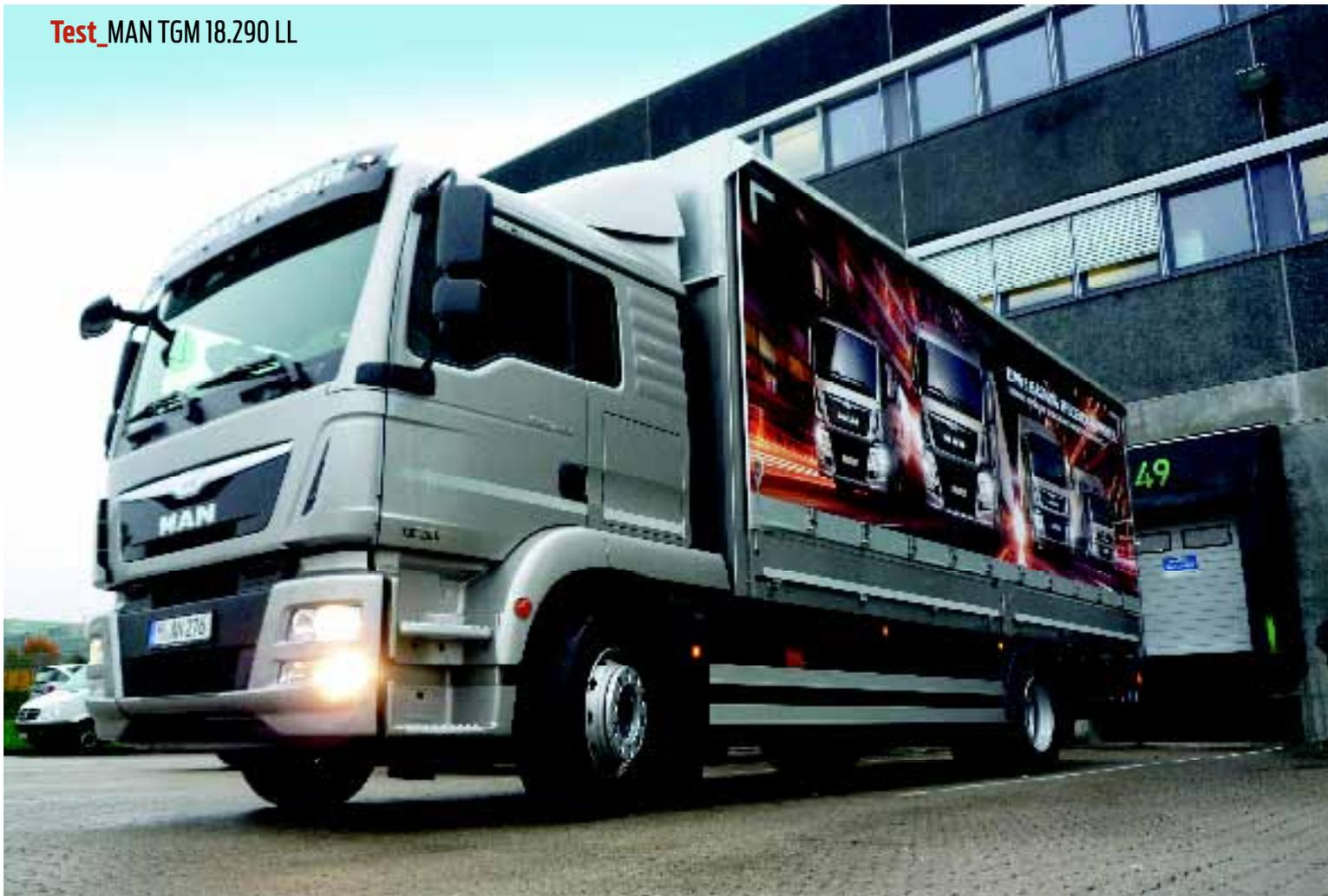
Für den schweren Verteiler-Verkehr: MAN TGM 18.290 mit kleinem Sechszylinder für mehr Nutzlast
