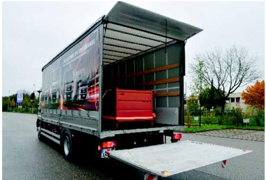
**Leichter Planenaufbau von Walther, Ladebordwand mit 2 t Hubkraft von Dautel**
