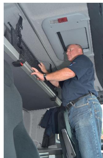
Der Aufstieg zur oberen Koje verlangt vom Fahrer sportlichen Einsatz, wegen fehlender Leiter.
