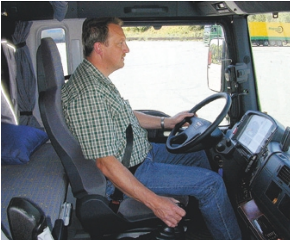
Die breite XL-Kabine des TG 410 A mit praktisch ebenen Fußboden ist für den 1-Mann-Einsatz im Fernverkehr konzipiert.
