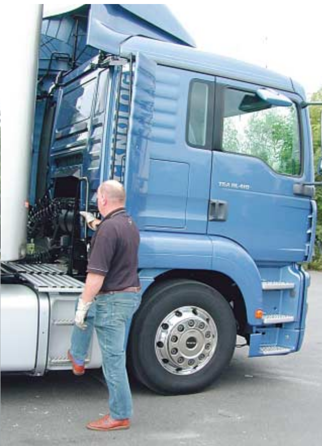
Der schwenkbare Seitenkantenspoiler vereinfacht das An- und Abkuppeln des Aufliegers. Die großvolumigen Außenstauflächen sind ein weiterer Pluspunkt der L-Kabine.
