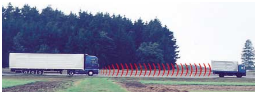
Der abstandsgeregelte Tempomat ACC arbeitet mit Radartechnik.
