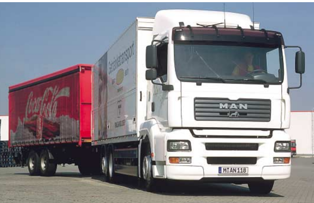
18 Europaletten fasst der Aufbau, 15.300 kg Nutzlast dürfen legal verladen werden (oben) Kräftig genug für den Anhängerbetrieb, aber erst mit dem 16-Gang-Getriebe sind 40 t möglich.
