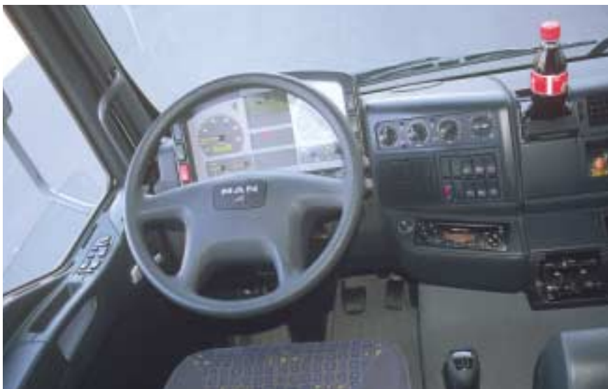
Der Arbeitsplatz – gut: die pneumatische Lenksäulen-Verstellung – weniger gut: fehlende Ablagen
