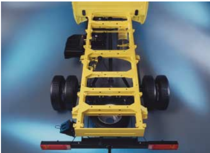
Der Rahmen des Sechstonners läuft kerzengerade vom Fahrerhaus bis zum letzten Querträger.
