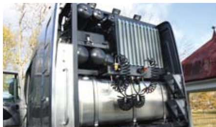
Von links: Turbokupplung; hydraulisches Anfahren, dann konventionell schalten mit der Trockenkupplung; Luftkessel, Tank und Teile der Kühlanlage sitzen aus Platzgründen hinter der Fahrerhausrückwand.
