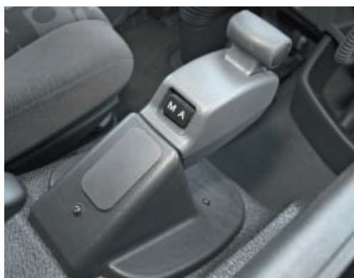
Vorbild Actros: Bedienteil und Schaltphilosophie der Telligent-Schaltautomatik 2 im Atego sind mit dem Actros identisch.
