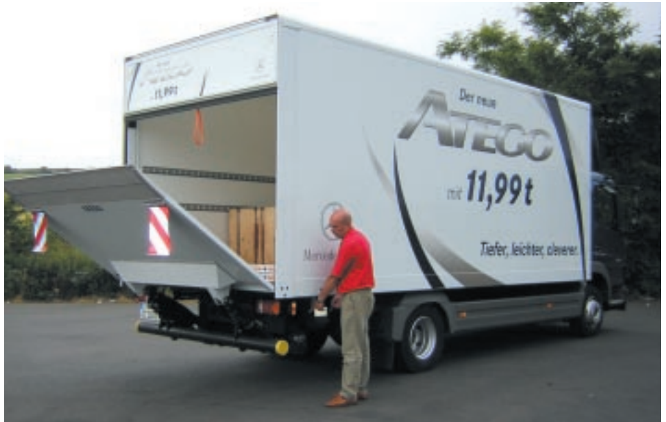
Viel Nutzlast: Das Testfahrzeug Atego NR 1222 L mit Kofferaufbau und Ladebordwand kann etwa 6,3 t Nutzlast aufnehmen.
