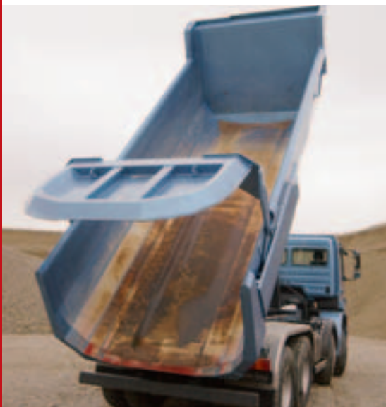
Bilder von links oben nach rechts unten: Vierachser mit Hinterkippaufbau – schnelle Umläufe mit einfachem Handling. Meiller-Hinterkipptechnik mit Stabilisator, die hinteren Kotflügel aus Alu-Riffelblech. Große Klappwand mit hydraulischer Fernbedienung – die Meiller-Halfpipe nimmt es auch mit größeren Brocken auf. Die Geländetalente sind limitiert – tief montierte Komponenten bekommen Bodenkontakt.
