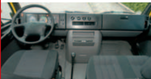
Flaches Armaturenbrett im Bauhausstil, ebener Boden, mittig die Motorkiste
