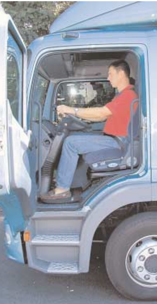
(links) Der Fahrer sitzt entspannt und verfügt über eine günstige Einstiegsituation mit niedrigem Kabinenboden sowie günstiger Trittstufenaufteilung.
