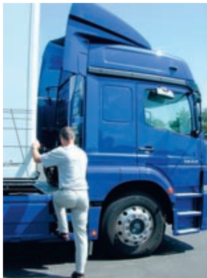
Trittstufen und eine begehbbare Plattform hinter der Kabine sichern den Fahrer beim An- und Abkuppeln des Aufliegers.
