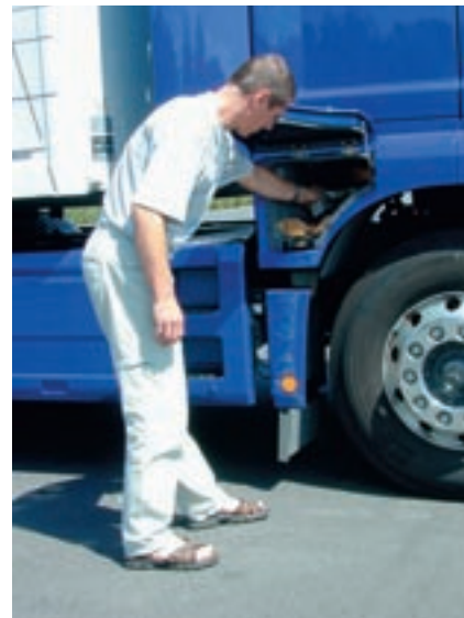
Werkzeug, Warnausrüstung und Tankutensilien lassen sich praktischer Weise in Außenstauflächen unterbringen.
