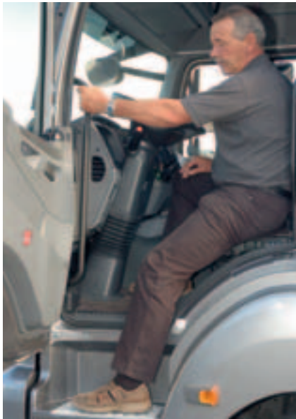
Sitzschnellabsenkung und hochklappbares Lenkrad sorgen für ein einfaches Aus- und Einsteigen.
