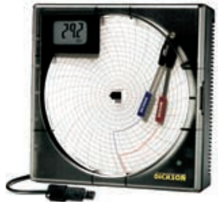
Diagrammschreiber der neuesten Generation mit hochklappbarem Stiftarm für den leichten Diagramm- und Stiftwechsel.
