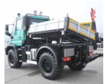
Von oben: erste Testfahrten mit fräsen, räumen und kehren. Der kleinste Unimog versieht als 10-Tonner seinen Dienst. Unimog U 423 mit Dreiseitenkipper.
