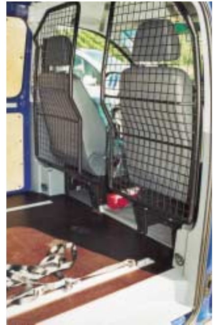
Ladungssicherung beim neuen Vito: Schutzgitter oder Trennwände gibt es in verschiedenen Versionen, Zurrösen sind im Boden und im Fußleistenbereich verankert, als Extra wird ein Holzboden mit Zurrschienen eingebaut.
