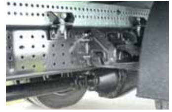
Eng gelochtes Raster für Fahrgestell- und Aufbauhilfsrahmen – hier muss der Aufbauhersteller nicht mehr bohren.
